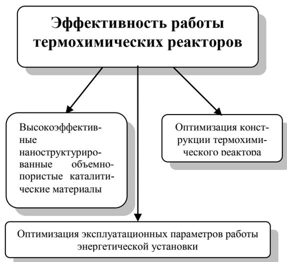
Рис. 2. Факторы, определяющие эффективную работу термохимических реакторов
