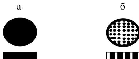
Рисунок 2. Базовые конструкции образцов на основе микропровода; а – полное заполнение отрезками микропровода, б- частичное заполнение отрезками микропровода
