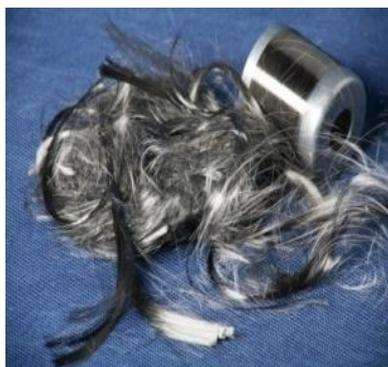
Рисунок 3. Микропровод из магнитного сплава
